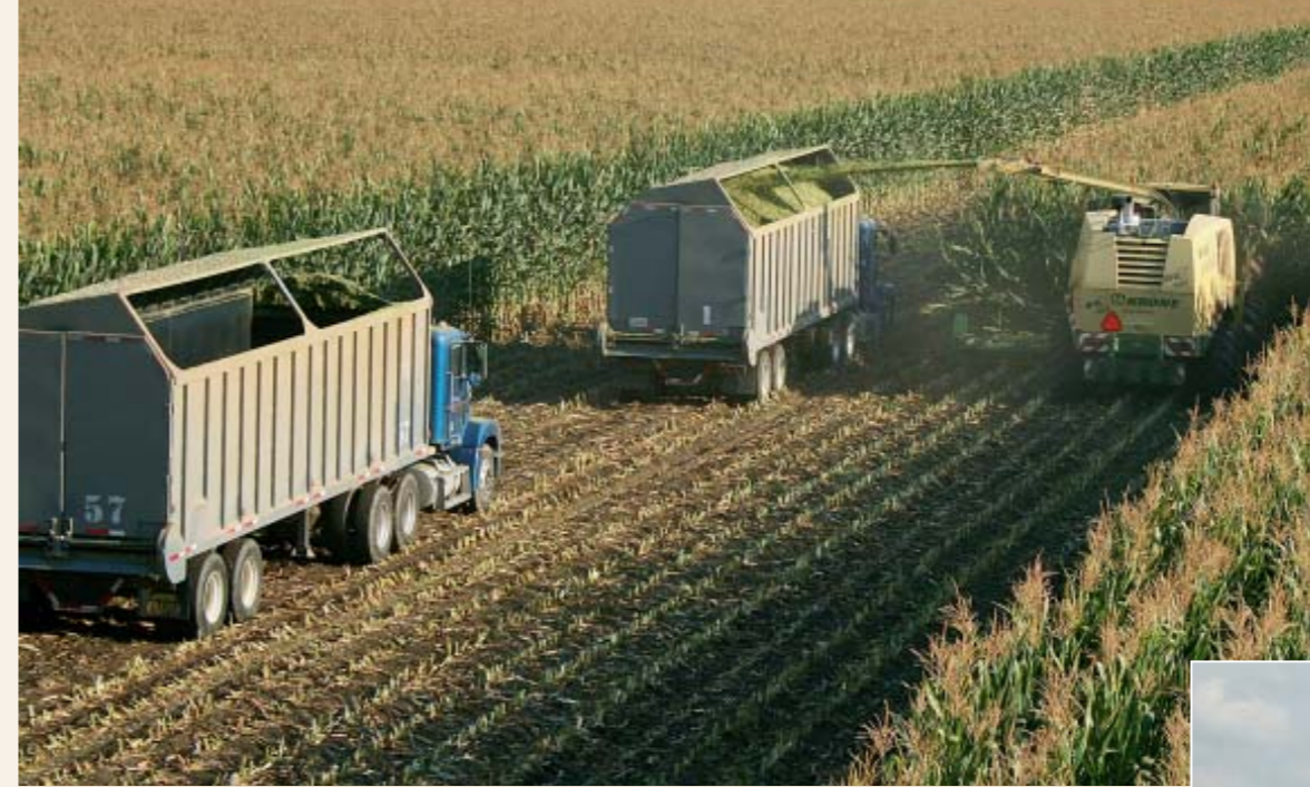
1000 PS vom Krone BiG X 1000 mit 12-reihigem EasyCollect in über fünf Meter hohem Mais in Kalifornien. Abgefahren wird nur mit Lkw und 55 m 3 großen Aufliegern. Fotos: Wilmer
